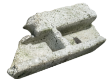
Vervuild EPS (door zand, cement etc.)
