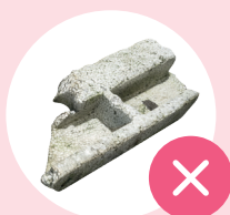
Vervuild EPS (door zand, verf, cement etc.)
