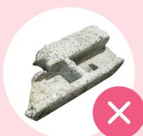
Vervuild EPS (door zand, verf, cement etc.)
